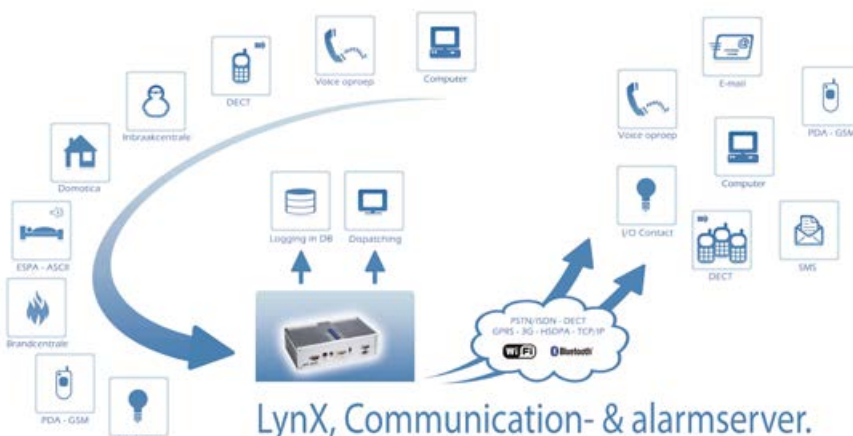
Strežnik LynX z naborem vhodnih vmesnikov in možnimi napravami za posredovanje obvestil.
